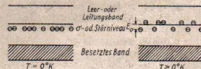
Abb. 3. Energiebandschema und Darstellung des Leitungsmechanismus eines Überschuß-Halbleiters (N-Typ)
