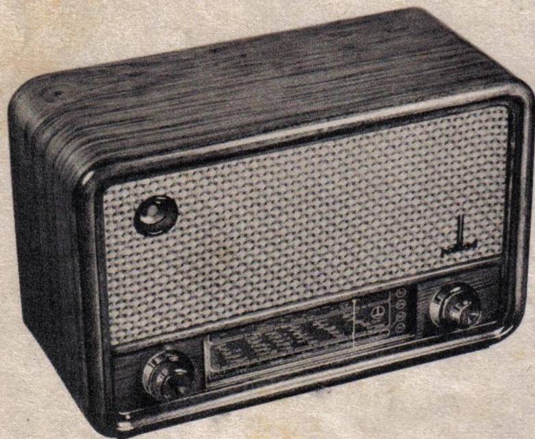
6 Röhren, 8 Funktionen, 6 Kreise, Kurz-, Mittel- und Lang-Wellen, abgestimmt auf den neuen Wellenplan, magisches Auge, mit 2 Anzeigebereichen, vorzugsgerichteter permanent-dynam. Vollton-Lautsprecher, kontinuierliche Tonblende, Bass- und Höhenanhebung. Anschlußmöglichkeiten für Tonabnehmer, UKW und 2. Lautsprecher, Flutlichtskala, poliertes Luxusgehäuse in Nußbaum. Umschaltbar 110/125/145/220/250 Volt Wechselstrom. Röhrenbestckg.: ECH 42, EF 41, EBC 41, EL 41, EM 34, AZ 41.
