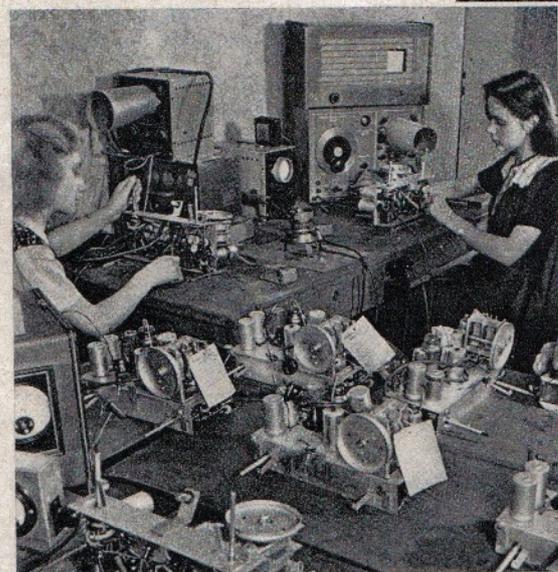
Prüfstand mit optischen Meßgeräten für die Zf-Einstellung und Bandfilter. Rechts: Neuzeitliche Druckmaschine zum Beschriften der Geräterückwände, die wie die Gehäuse und Einzelteile ebenfalls im Werk hergestellt werden
