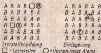
Abb. 1. Unvollkommene Kristallgitterbildung einer angenommenen Verbindung A-B. Links: Fall der Leerstellenbildung, wodurch überschüssige Atome entstehen. Rechts: Fall der Einlagerung von Atomen, entweder auf einen vorhandenen Gitterplatz oder zwischen den Gitterplätzen
